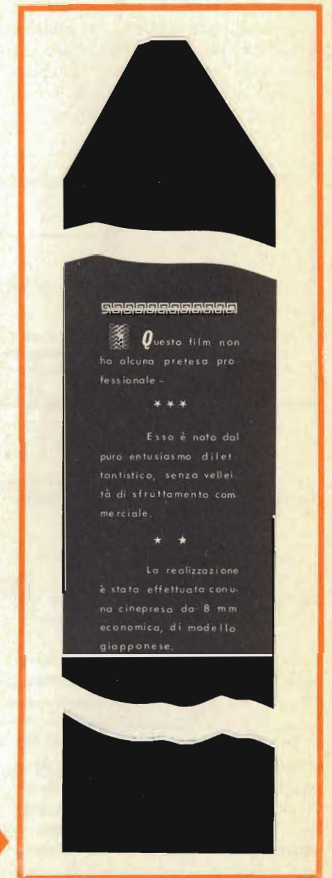
Fig. 3 - Altro accorgimento applicabile alla titolatrice descritta, per ottenere l'effetto delle scritte che compaiono dal basso e scompaiono nel bordo superiore dell'immagine. L'originale consiste in una striscia avvolta sul rullo inferiore, e trascinata verso l'alto da quello superiore. L'inizio della striscia viene fissato al rullo di trascinamento con un po' di nastro adesivo.
