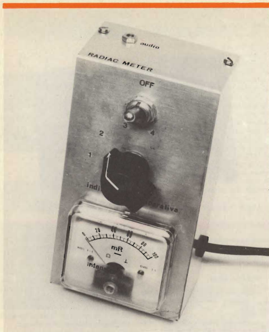
Aspetto del contatore pronto all'uso. La scala dell'indicatore, reca la scritta « mR » (milliRoentgen) che è puramente indicativa, non essendo la scala medesima calibrata per una indicazione assoluta, ma comparativa. Sopra all'indicatore si nota la manopola che controlla il commutatore di portata. Alla sommità è fissato l'interruttore generale. Sul lato superiore della scatola, è posto il jack dell'uscita audio: una cuffia inserita in tale jack può permettere l'ascolto degli impulsi.
